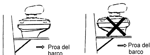
Figura 6-7. Como orientar la antena
